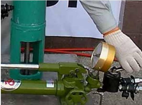
方向制御弁のハンドルを加圧側に切り替えます。
