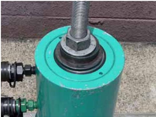
ナットをセットして、軽く締め付けます。
