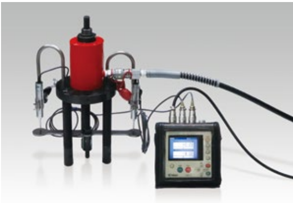
油圧式試験装置+変位変換器との組合せ
