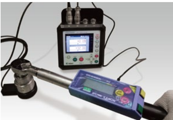
レンチ式試験装置+トルクレンチとの組合せ
