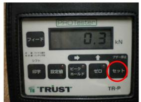
⑥ 荷重設定入力後、セットボタンを押し、 設定を完了します。
