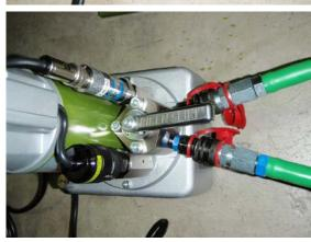
① 方向制御弁のハンドルを中央位置に 切換えます。
