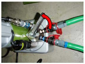
⑩ 作業終了時は、方向制御弁のハンドルをBポート側に切換えて降圧します。
