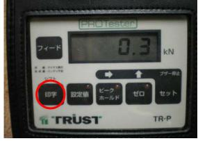
※「Pr」・「PE」が表示される場合や印字が 薄い場合は、新しい電池に交換して下さい。
