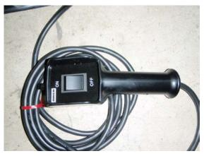
② 操作スイッチを『ON』にすると モーターが起動し、作動油が吐出される 状態になります。
