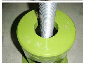
③ 反力台(ラムチェア)の中心が ボルトの中心に来るよう設置します。
