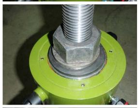
⑥ ワッシャー、ナットをセットして、 軽く締め付けます。
