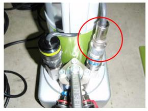
⑨ ディジタルプリンター付表示機と 圧力変換器に接続ケーブルを 締め付けます。
