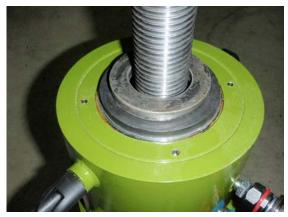
(5) ボルトサイズに適合するTI-150用座金、 センターシャフト用のワッシャー をセットします。
