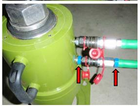
⑦ 油圧ホースのキャップをはずし、 センターホールシリンダーと油圧ポンプの カプラにカチっと音がするまで 押してはめ込みます。
