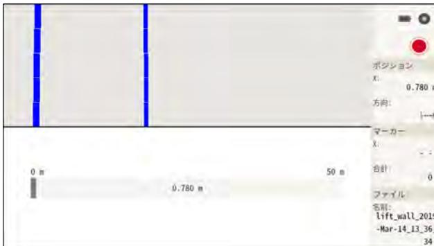
5. ボタンで測定を開始します。測定の開始を知らせるトーン信号が聞こえ、情報エリアに記録位置が赤く表示されます。評価可能なデータを得るためにには、30 cm (11.81 インチ) 以上の距離をスキャンしてください。最低長に達すると進捗バーの色が変わります。最大スキャン長は 50 m (164 フィート) です。
