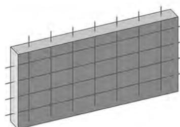
パラメーター‘探査モード’（‘自動’または‘メッシュ’）が設定されていて鉄筋メッシュが検出された場合、事前設定されている直径（範囲を含む）は無視され、システムは鉄筋直径 8 mm (0.31 インチ) を検知の開始値としていることに注意してください。
