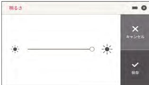
画面の明るさを変更するには、レギュレーターを左右に動かします。
