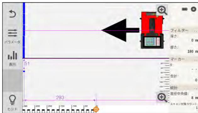
探査する面における実際の移動方向に応じてスキャン方向を選択します。
