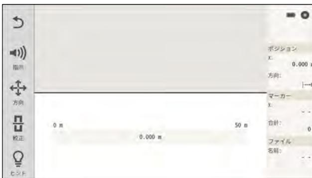
これらの機能により、コンクリート構造物内の長い距離を記録することができます。スキャン方向に対して垂直の位置にある鉄筋は、記録の終了の後平面図表示および断面図表示により表示させることができます。記録されたスキャンは、現在のプロジェクトに保存されます。ファイル名は情報エリアに表示され、タップして変更することができます。
