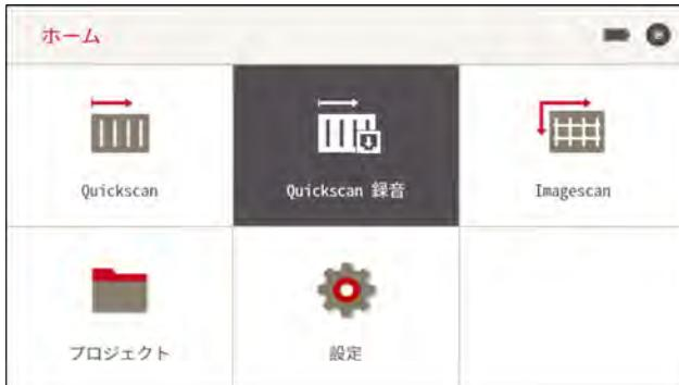
メインメニューおよびダイアログボックスにおいて、背景がグレーのボタンを ボタンによりタッチスクリーンに触れることなく操作できます。これにより、PS 300 を片手で操作できます。
