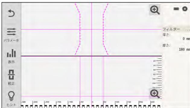
この機能により、コンクリートおよびその他の非鉄建設資材中の鉄筋の位置を測定し、リアルタイムで表示することができます。スキャン方向に対して垂直の位置にある鉄筋は、平面図および断面図により表示され、マーキング用切り込みにより探査面に直接マーキングすることができます。
