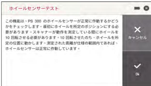
この機能により、ご使用のPS 300 の距離センサーが正しく機能しているかどうかテストすることができます。テストを開始するには、 ボタンをタップします。破棄するには ボタンをタップします。続いて、画面の指示に従います。
