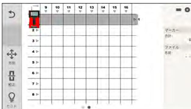
この機能は、コンクリート構造物内の鉄筋を平面的に表示するのに使用します。鉄筋は平面図で表示されます。
