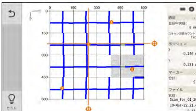
最後にスキャンされた測定軌道の後、自動的にイメージスキャンプレビューに移動します。
