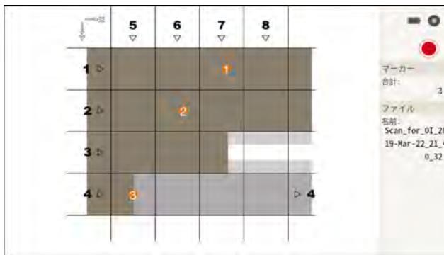
6. **●** ボタンで測定を開始します。測定の開始を知らせるトーン信号が聞こえ、情報エリアに記録位置が赤く表示されます。評価可能なデータを得るためにには、30 cm (11.81 インチ) 以上の距離をスキャンしてください。最低長に達すると進捗バーの色が変わります。
