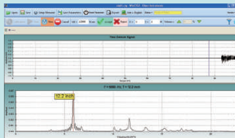
コンクリート厚さ測定法概要（上：受信波形・下：周波数解析結果）
