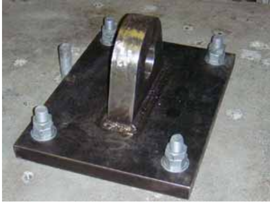
試験体例(リブ溶接)
