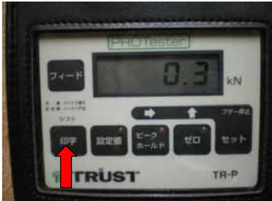
[印字]ボタンを押し、測定データをプリントします。
